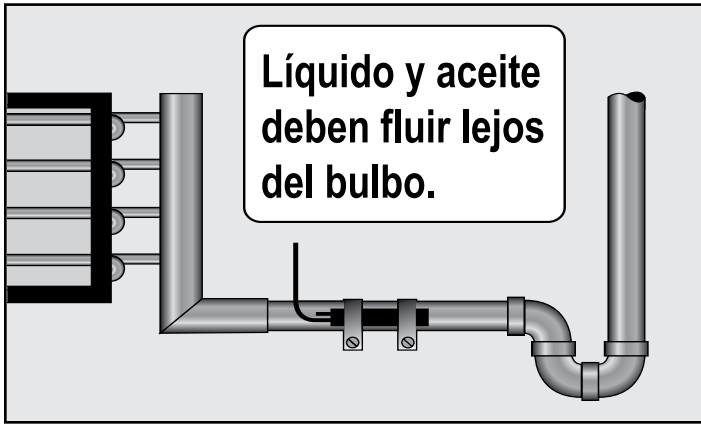
El bulbo sensor deberá estar bien sujetado en una sección horizontal, limpia y recta de la tubería de succión a la salida del evaporador.
