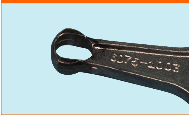
Figura 2 – Un agujero/hueco del pasador del pistón de la biela desgastado
