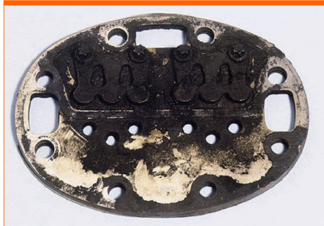
Figura 4 – Plato de válvulas con depósitos de la descomposición del aceite
